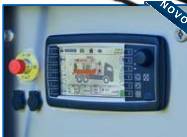
Upravljački panel s zaslonom osjetljivim na dodir i grafičkom vizualizacijom radnih procesa. Dokazani sustav održavanja na daljinu KAISERteleservice
