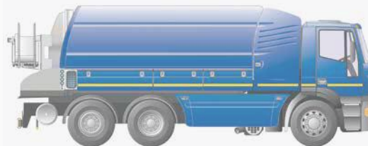
Čista voda u bočnim spremnicima izrađenim od polietilena ili nehrđajućeg čelika
