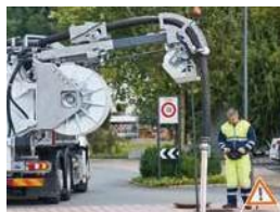
Kombinirana ruka usisno i visokotlačno crijevo
