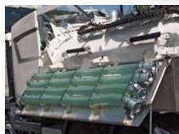
Držači crijeva - hidraulično pokretani, upravljanje daljinskim telekomandama
