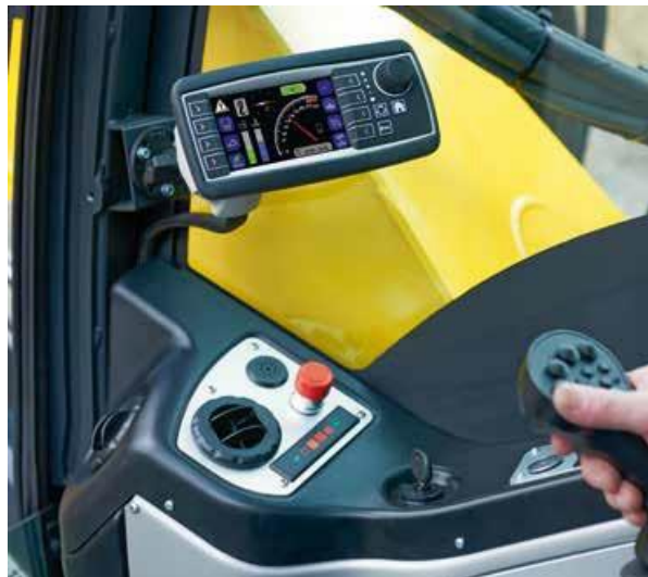
Joystick s 28 funkcija (proporcionalne i digitalne), posebno dizajniran za pokretni hodajući bager
