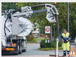
Kombinirana ruka usisno i visokotlačno crijevo
