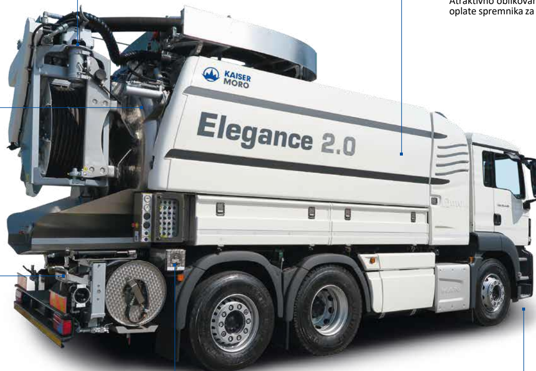
Kombinirana ruka usisno i visokotlačno crijevo
