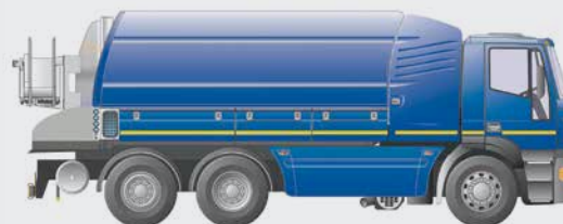
Čista voda u bočnim spremnicima za vodu izrađenim od polietilena ili nehrđajućeg čelika
