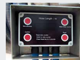
Brojač odmotanih metara visokotlačnog crijeva
