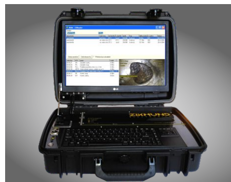
SUSTAV KONTROLE UPRAVLJAČKA JEDINICA
