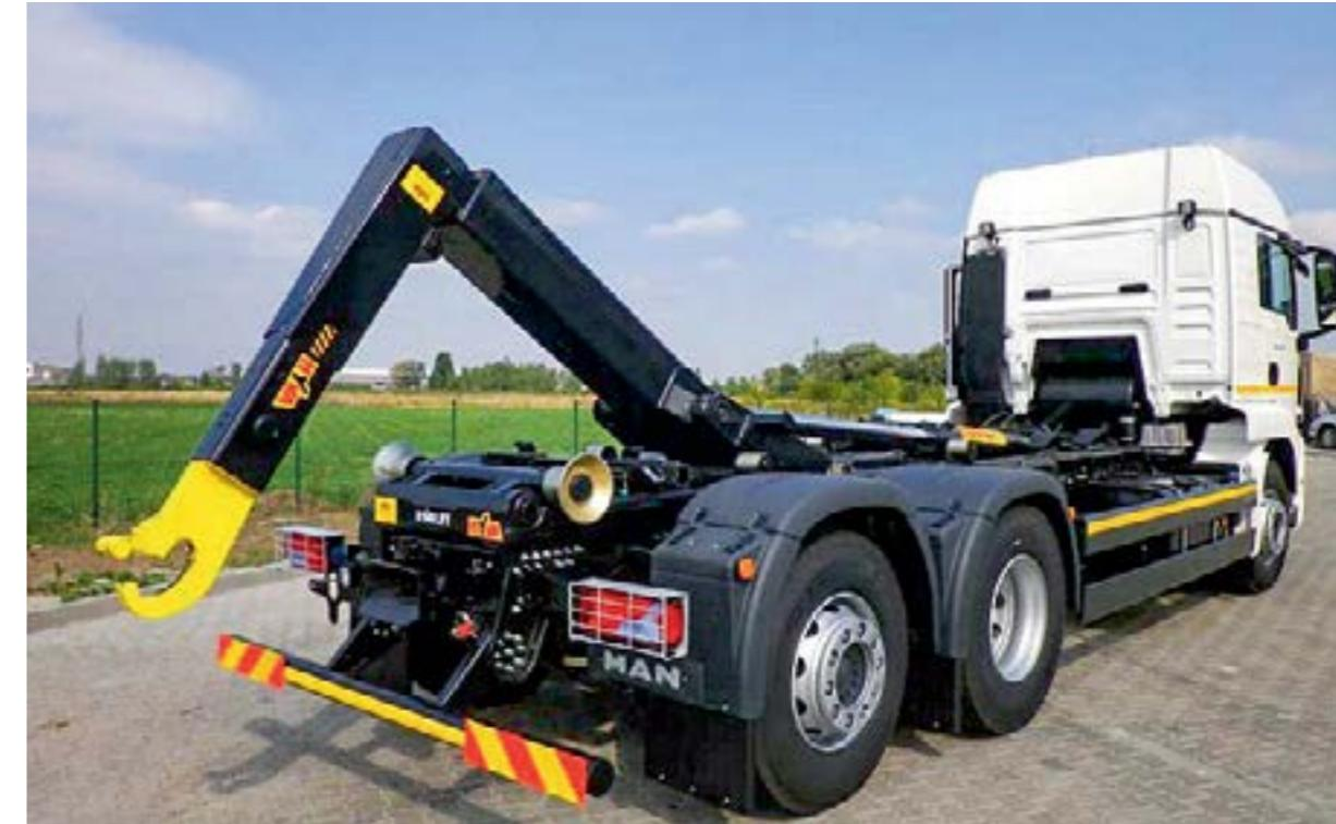
**Autopodizači** dostupni u različitim verzijama od 4 t do 18 t. Mogućnost ugradnje na vozila najviše dopuštene mase od 4 t do 32 t. Dostupni u verzijama sa fiksnim, hidraulički izvlačivim i zglobovnim rukama.
