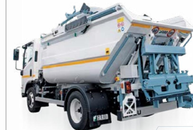
○ MK1 – Kipajuće nadogradnje zapremine od 5m<sup>3</sup> i 7m<sup>3</sup>
