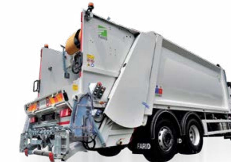
○ T1 PLUS - Nadogradnje sa stražnjim vratima zapremine od 10m<sup>3</sup> -30 m<sup>3</sup>
