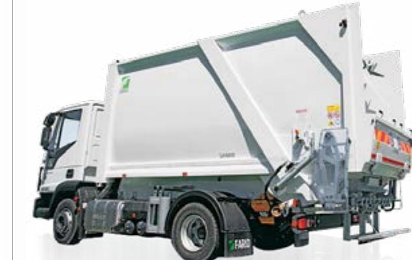
○ PN - Nadogradnje izvedene u potpunosti iz jednog dijela zapremine od 7m<sup>3</sup> - 15m<sup>3</sup>
